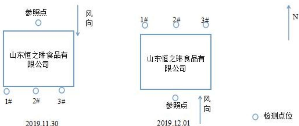
图 6-2 厂界无组织废气监测布点图
